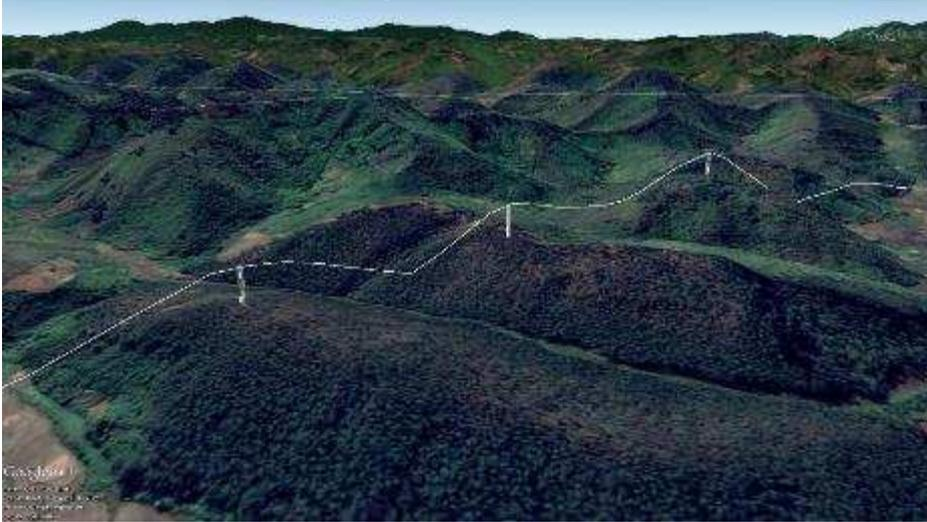
Figure 16: Implantation des pylônes en haut des sommets permettant de préserver les arbres dans les vallées et bas de coteaux
